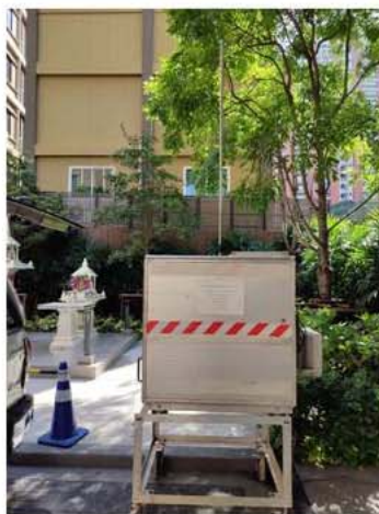
ภาพที่ 5 ติดตั้งเครื่องตรวจวัดก๊าซมลพิษทางอากาศ \text{CO}_2 , \text{SO}_2 , \text{NO}_2 , HC
